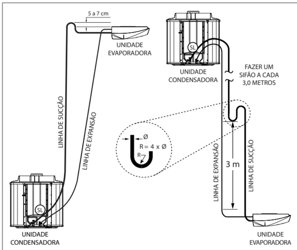
FIG. 26 - INSTALAÇÃO LINHAS DE INTERLIGAÇÃO
