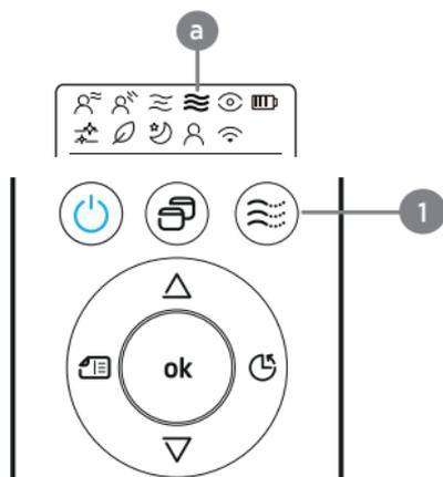
1. Pressione a tecla “Breezeless” para selecionar uma suave brisa; a unidade configura automaticamente os defletores para uma posição mais fechada e reduz a velocidade do ventilador, proporcionando desta maneira uma sensação de maior conforto térmico.
