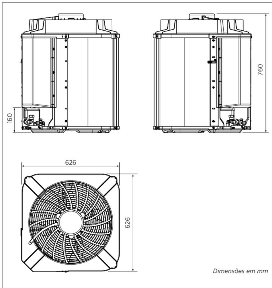
FIG. 6B - DIMENSIONAL UNIDADES CONDENSADORAS 38CQVE48 / 38CCVE60
