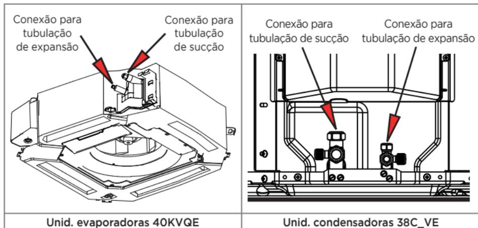
FIG. 28 - CONEXÕES DE INTERLIGAÇÃO
