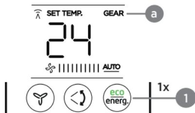
1. Pressione a tecla **eco energ.** uma vez (1x), o ícone da função fica acessado no display do controle ("a" na figura acima) e a partir deste momento a unidade iniciará a operação no modo economia de energia.
