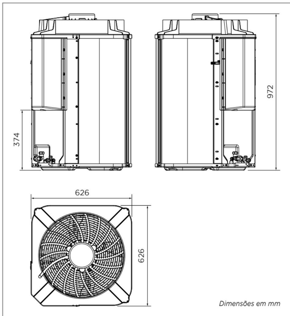
FIG. 6C - DIMENSIONAL UNIDADES CONDENSADORAS 38CQVE60
