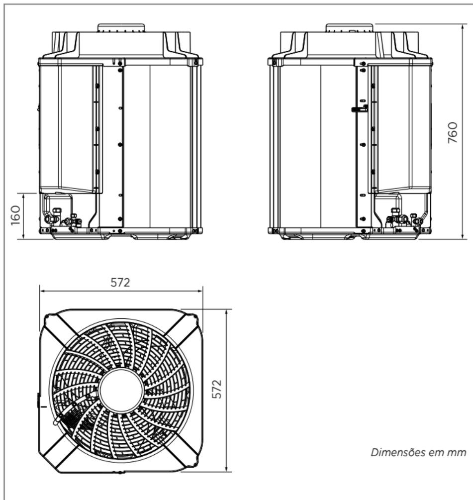
FIG. 6A - DIMENSIONAL UNIDADES CONDENSADORAS 38C\_VE36 / 38CCVE48
