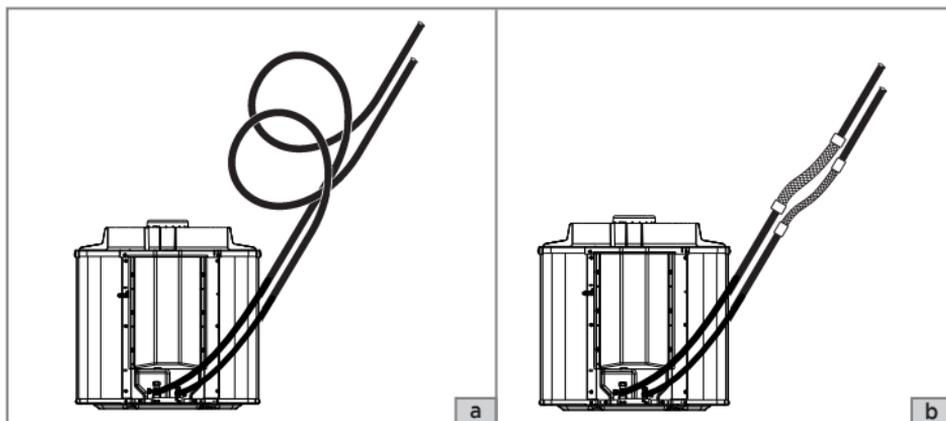
FIG. 27 - INSTALAÇÃO DOS LOOP'S E TUBOS FLEXÍVEIS
